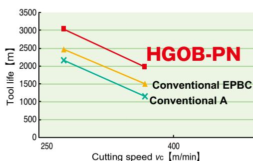
Cutting conditions  $n=20,000\text{min}^{-1}$   $v_f=8,000\text{mm/min}$
