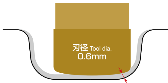
最大削り残し量: 0.04mm Max. remaining amount
