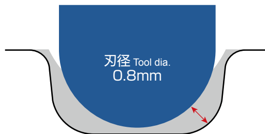
最大削り残し量: 0.12mm Max. remaining amount
